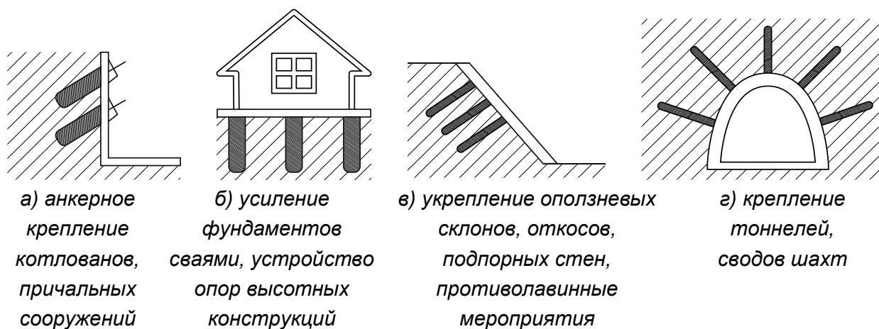
Рисунок 4.1. Варианты применения грунтовых анкеров, свай и нагелей Атлант
